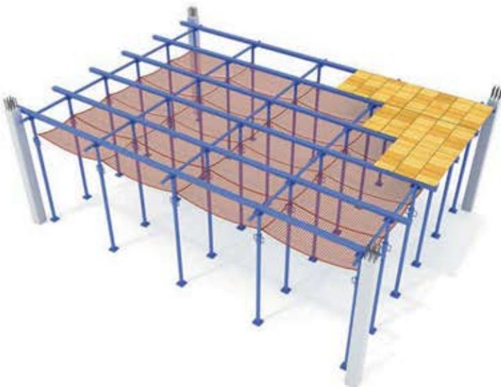
این نوع از پر کابردترین انواع روش های اجرای توری می باشد که در ساختمان ها ، سازه های صنعتی ، پل ها .... کاربرد دارد. جنس این توری ها از پلی استر و پلی آمید می باشد که ضمن مقاومت کششی بالا در برابر اشعه یو وی نیز بیشترین مقاومت را دارند باfte می شود.
