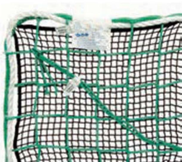
توری های سپر حفاظتی از نوع کلاس B1 دارای دو لایه توری از جنس پلی استر و پلی آمید با چشمeh های  $100*100$  میلی متر و  $20*20$  میلی متر می باشد و همچنین دارای مقاومت تحمل وزنه ۱۰۰ کیلوگرمی از ارتفاع ۷ متر مطابق با استاندارد EN ۱۲۶۳ - می باشد.
